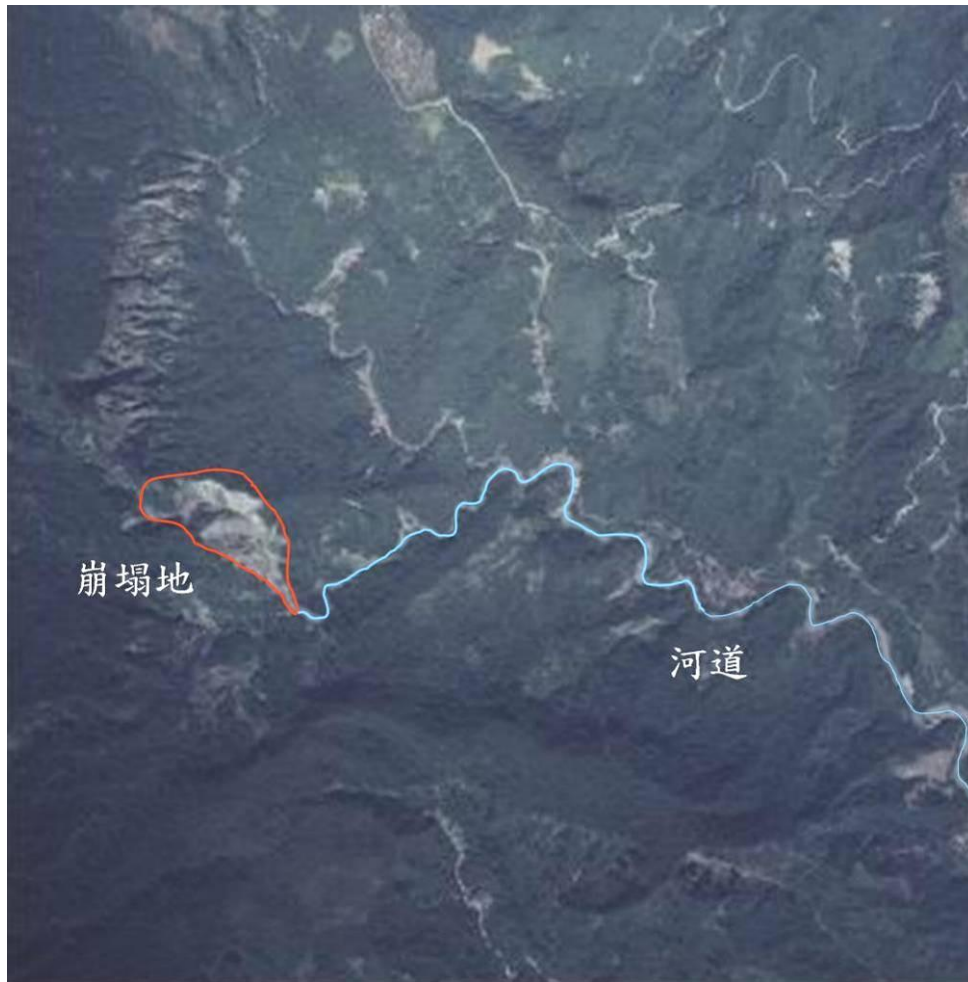
圖 2-2 正射影像圖判釋崩塌地、河道情形示意圖
