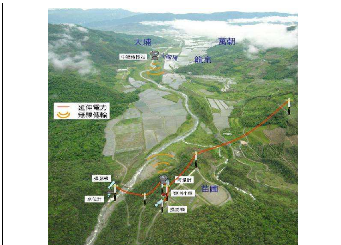
圖附錄 3-1 龍泉溪堰塞湖土砂觀測系統儀器位置圖(1)
