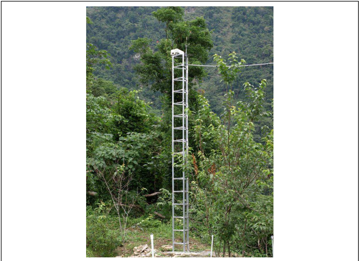
圖附錄 3-6 二號攝影機、紅外線投射燈架設圖
