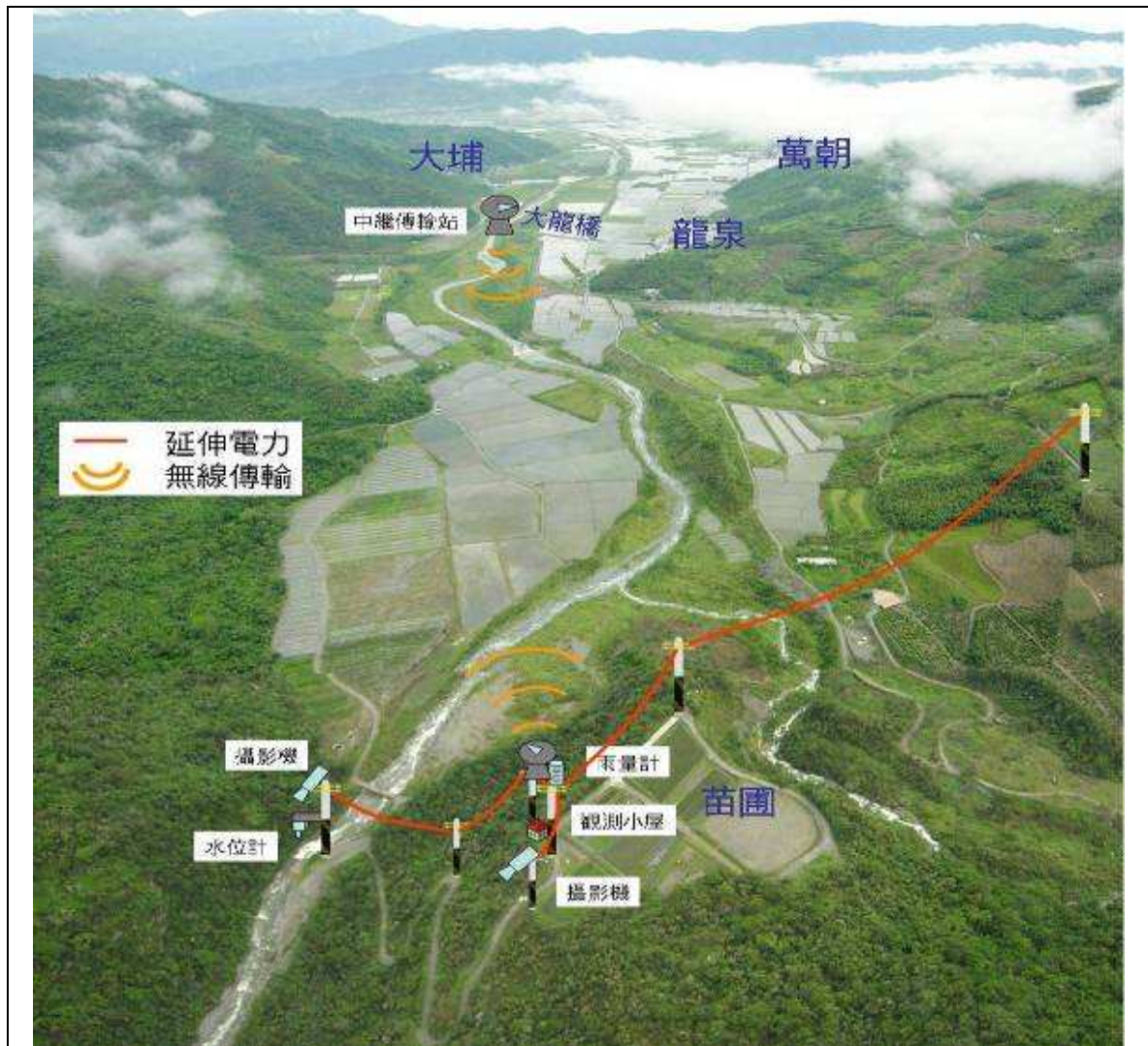
圖 3-0-1 龍泉溪堰塞湖土砂觀測系統儀器位置圖
