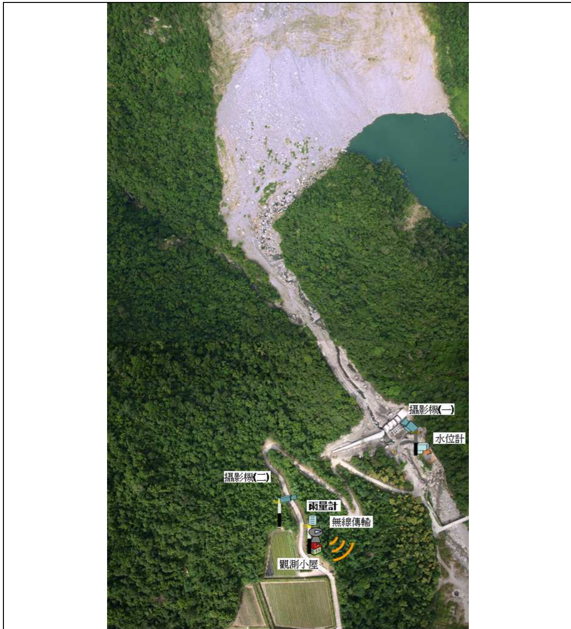
圖 3-4-2 龍泉溪堰塞湖土砂觀測系統現場儀器位置圖
