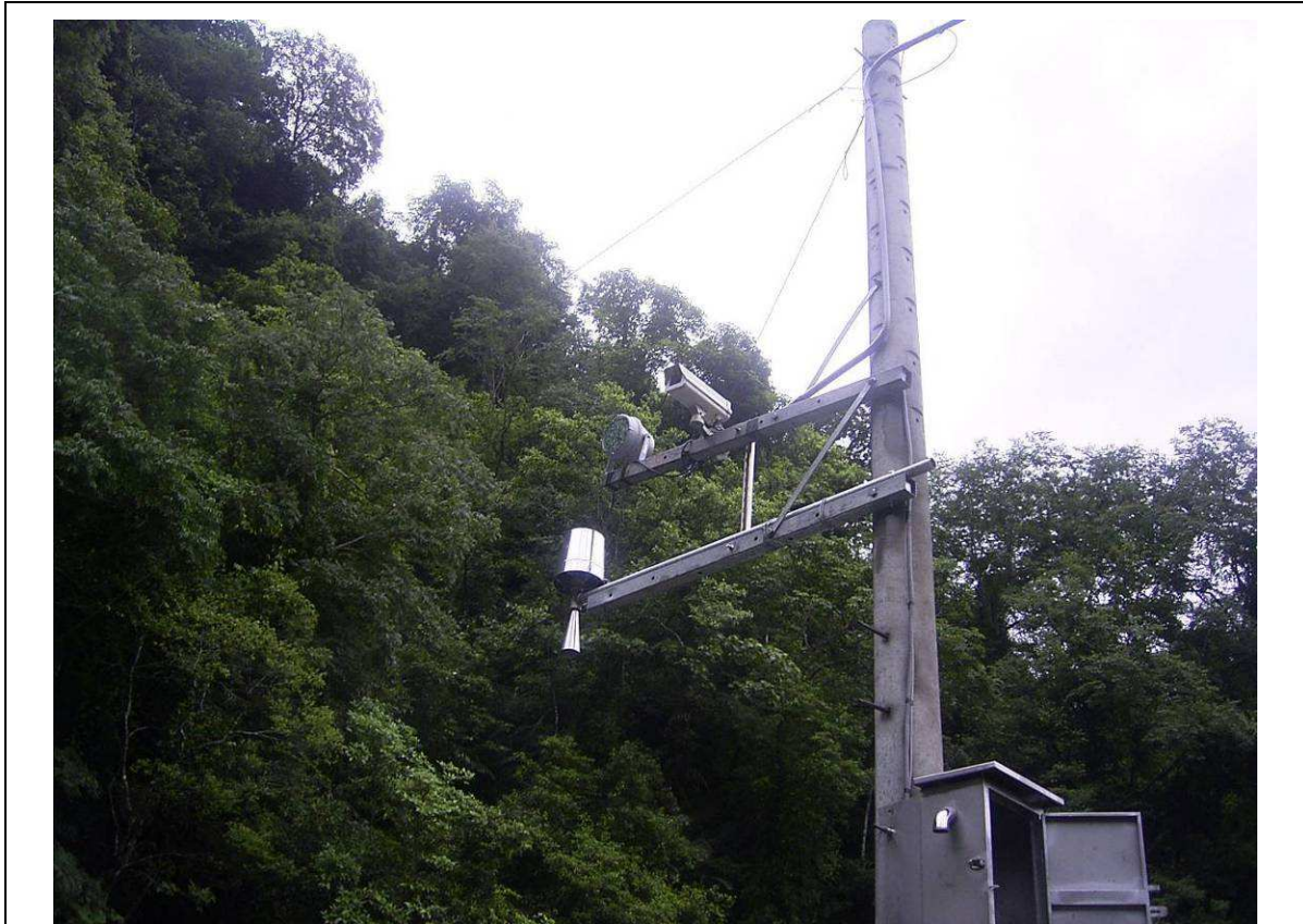
圖 3-2-6 水位計架設圖
