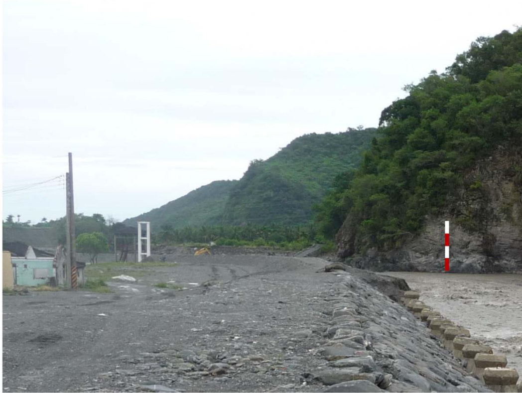
圖8-4.1 嘉蘭村對岸山壁人工監測水尺示意圖
