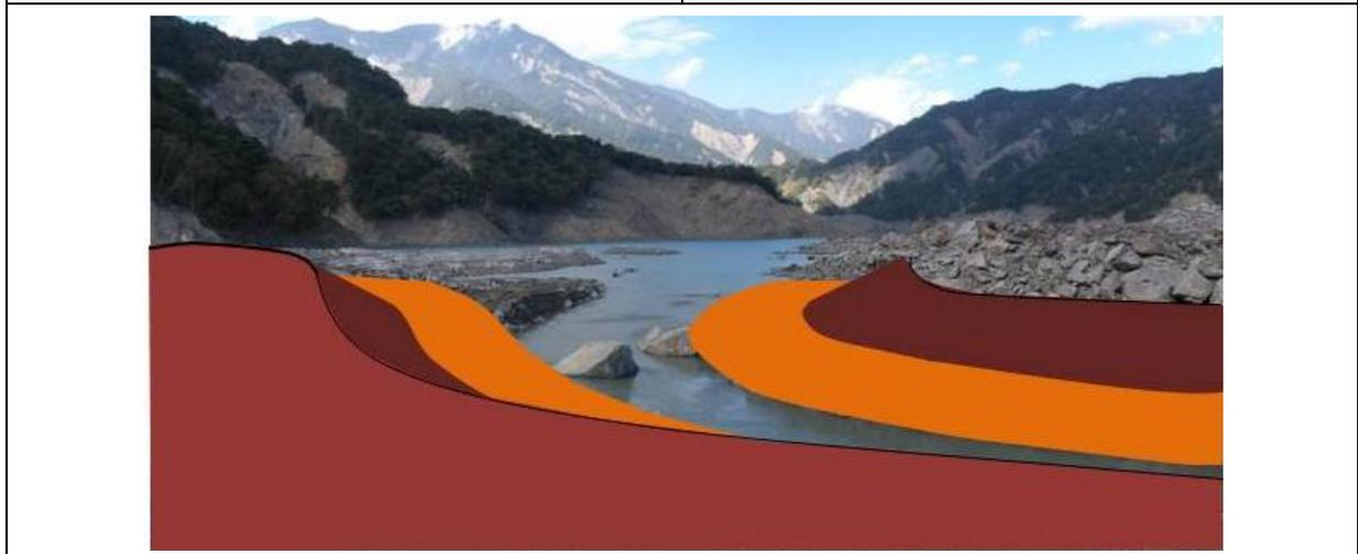
圖7-3.1 溢流水道改善工程(通水断面加大、複式断面，喇叭口設計)
