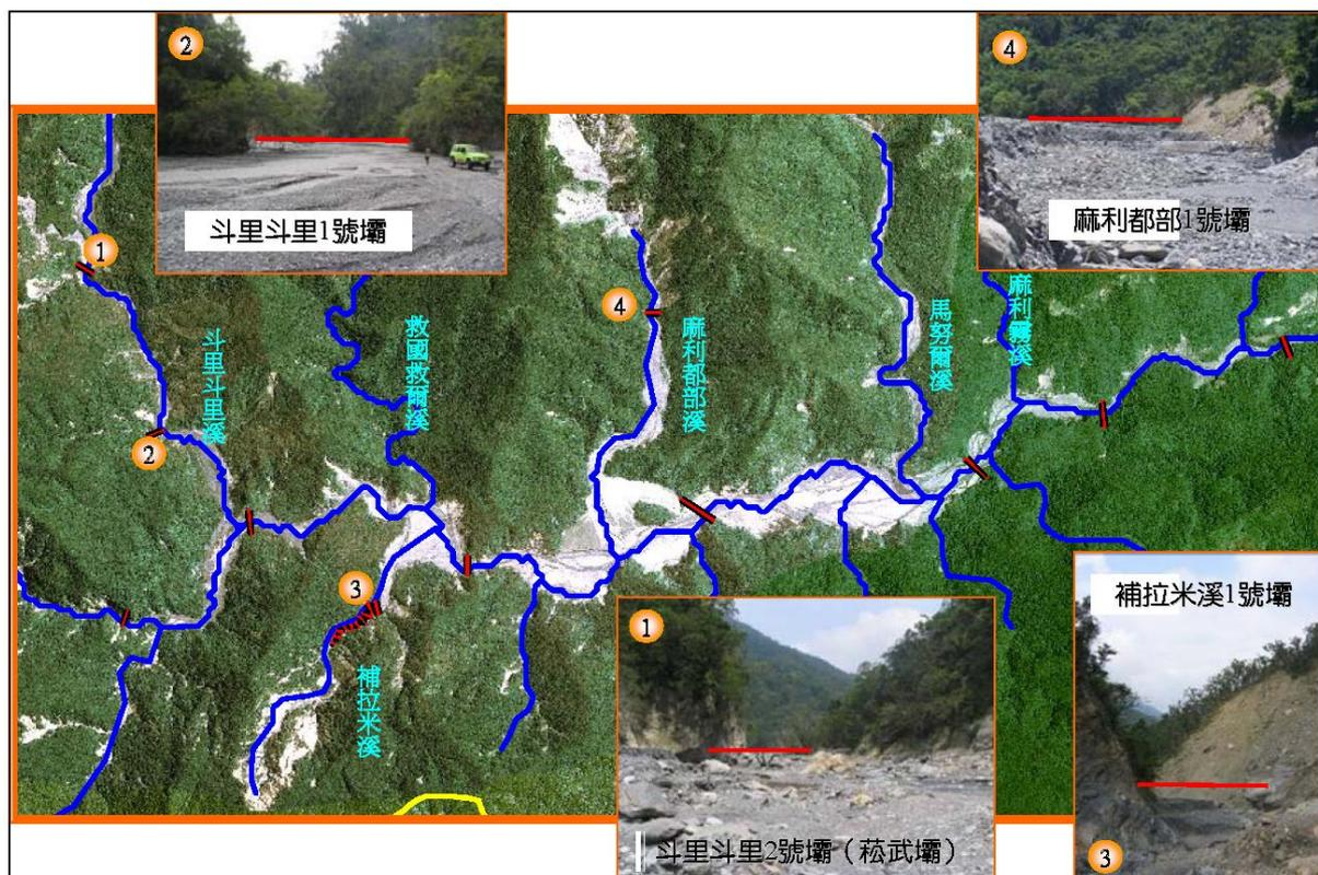
圖7-5.3 支流、野溪建議設置防砂壩位置示意圖
