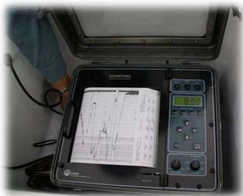
(a) 單音束測深儀(美製 ODOM Hydrotrac)
