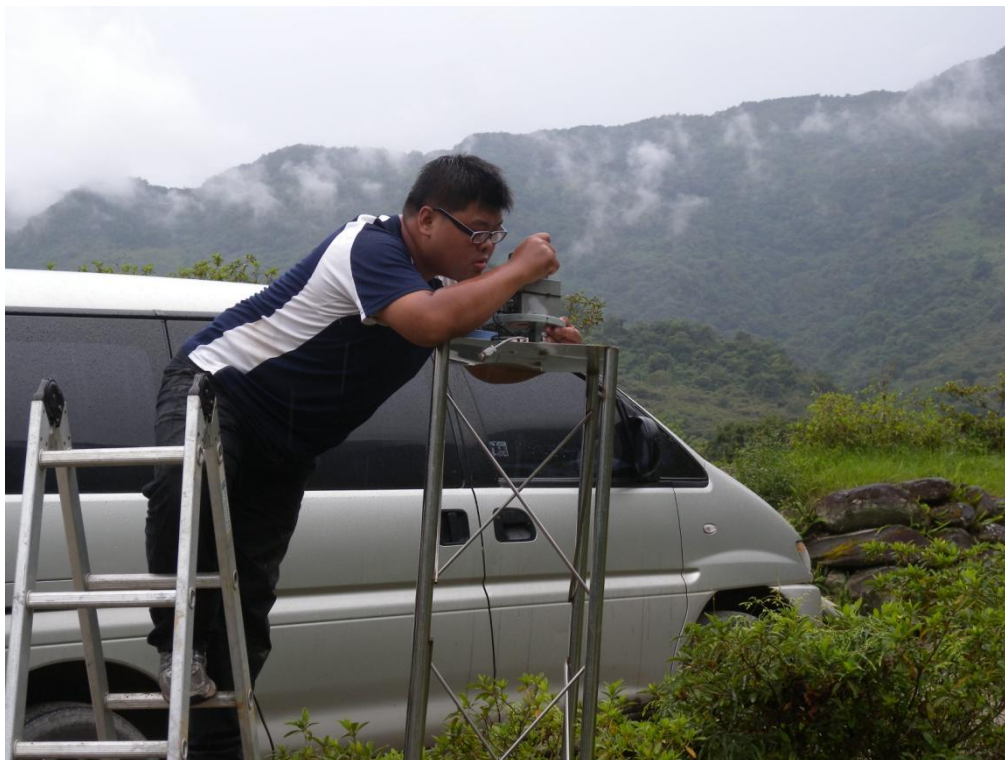
圖 3-3.15 調整雨量筒水平（6 月 25 日）
